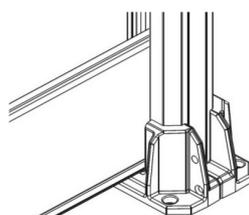
**Remarque :** Il est possible de fixer au préalable la lisse basse à la première lame au moyen d'une vis inox Ø4 à tête fraisée (non fournies), en prenant toutes les précautions nécessaires pour ne pas fissurer la lame.
