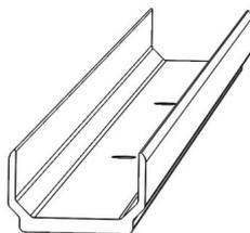
**C111. INSÉRER** la lisse basse dans l'ouverture de la platine, en appui contre le poteau.
