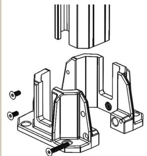
A22. POSITIONNER l'ensemble platine + poteau sur la dalle béton.
