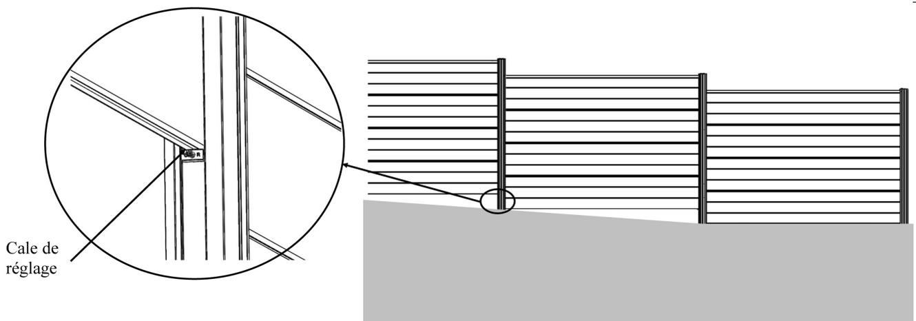
Remarque : dans ce type de configuration, lorsqu'il est possible d'enterrer partiellement les lames, il est plutôt conseillé d'utiliser la plaque de sous-bassement en guise de première lame.
