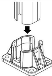
A13. VISSER ensuite les vis de pressions à l'aide d'une clef allen M8 sur les poteaux jusqu'à ce que l'ensemble n'ait plus de jeu (serrage à la main).
