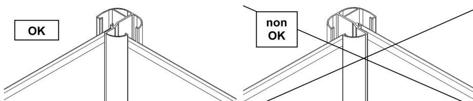
**ATTENTION** : lors de la pose de claustras avec poteaux d'angle, il est **IMPÉRATIF** d'haubaner les poteaux pour une résistance accrue au vent (au delà de 90km/h).
