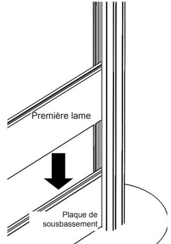
**C121.** Une fois le béton solidifié, **INSÉRER** la plaque de sous-bassement dans la gorge du poteau, et la faire reposer sur le socle en béton.
