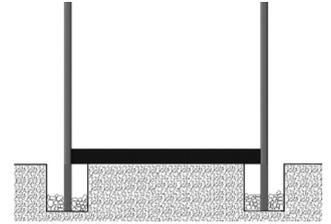
**B2. Pré-positionner** les poteaux dans les trous.
