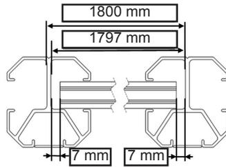
**B4. SCÈLER** les poteaux avec du béton tout en prenant soin de vérifier la verticalité (à l'aide d'un niveau), la hauteur et l'entreaxe des poteaux, lors du remplissage des trous.
